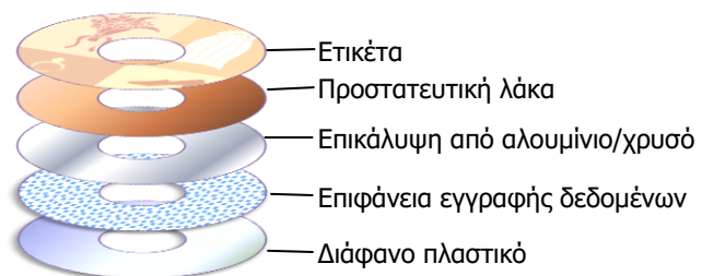
Εικόνα 25 Δομή ενός Οπτικού δίσκου
