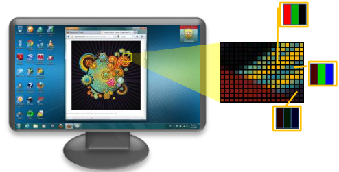
Εικόνα 35 Μια οθόνη αποτελείται από εικονοστοιχεία, το καθένα από αυτά έχει τρεις φωτεινές πηγές, για κόκκινο, πράσινο και μπλε χρώμα
