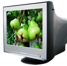
Εικόνα 37 Οθόνη καθοδικού σωλήνα
