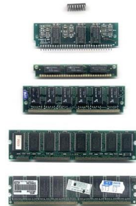
Εικόνα 18 Διάφοροι τύποι μνήμης RAM (σε ανατύπωση από wikipedia.org). Από πάνω προς τα κάτω, DIP, SIPP, SIMM (30-pin), SIMM (72-pin), DIMM (168-pin), DDR DIMM (184-pin).
